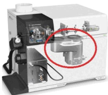
Высокопроизводительный турбонасос с делением потока и внешний форвакуумный насос обеспечивают необходимый вакуум в зоне интерфейса, повышая чувствительность и улучшая устойчивость к матрице;
