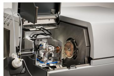
Самое удобное обслуживание плазменного блока - простой доступ ко всем элементам блока (достаточно нажатия кнопки). Производится автоматическая юстировка горелки после технического обслуживания. Конусы установлены на резьбе, что упрощает доступ при регламентном техническом обслуживании;
