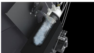
Уникальная патентованная технология UHMI - ввода проб со сверх высоким содержанием матрицы позволяет проводить анализ проб с общим содержанием солей до 25% без предварительного разбавления. Аэрозоль пробы после инъекции "разбавляется" аргоном, поступающим в систему UHMI через автоматический высокоточный дозирующий
