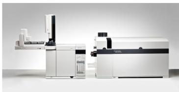
Передовые технологии измерений для определения валентных форм элементов. Масс-спектрометр с индуктивно-связанной плазмой 8800 легко интегрируется с системами ВЭЖХ и ГХ при помощи хорошо зарекомендовавших себя интерфейсов управления на основе интегрированного
