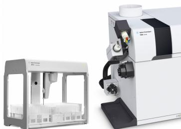
При использовании дополнительной системы оптимизации ввода проб (ISIS 3) ([ссылка на аксессуары для ИСП-МС](#)) и нового автосамплера SPS 4 вы можете значительно снизить себестоимость анализа при сохранении высокого качества данных и, тем самым, повысить рентабельность лаборатории.
