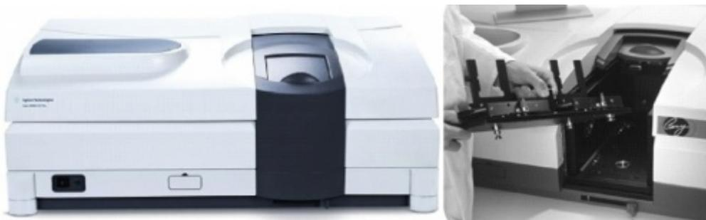
**Agilent Cary 4000** - это спектрофотометр УФ-ВИД исследовательского класса, предназначен для работы в спектральном диапазоне 175-900 нм и может быть использован в качестве референсного спектрофотометра в полупроводниковой промышленности и системах телекоммуникаций. Огромный выбор различных приставок и аксессуаров для анализа как жидких, так и твердых образцов. Управление спектрофотометрами осуществляется с помощью модульного программного обеспечения **CaryWin UV**.
