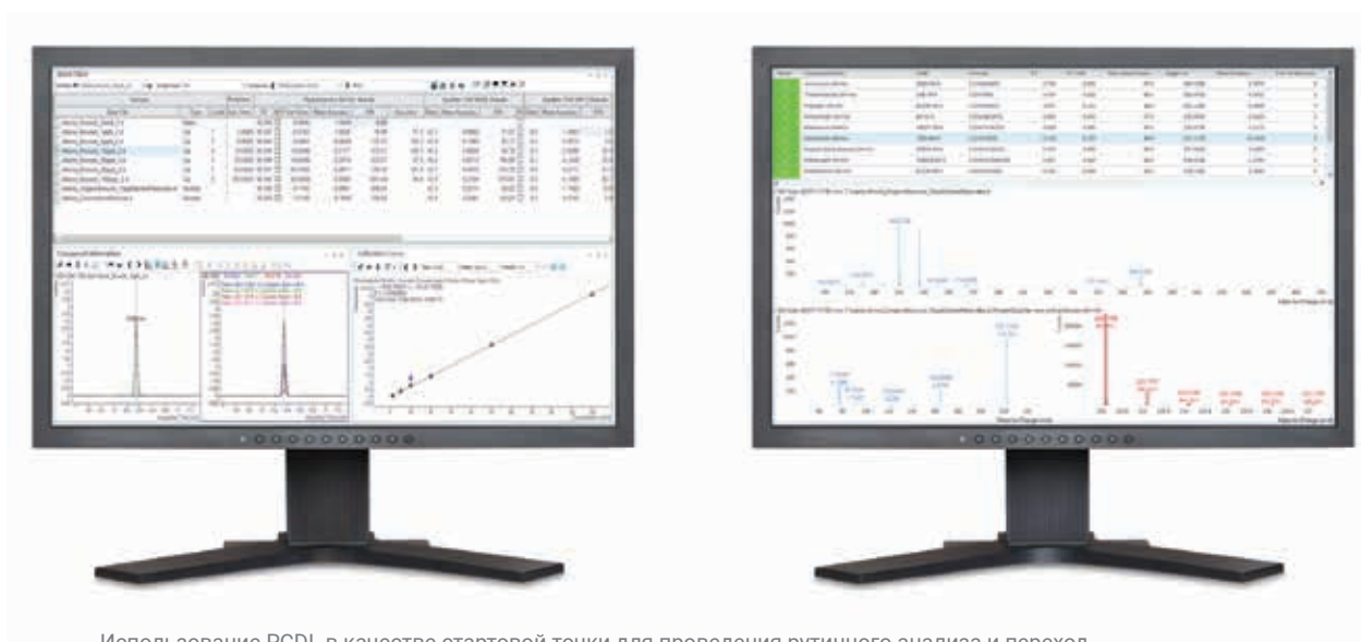
Использование PCDL в качестве стартовой точки для проведения рутинного анализа и переход либо к классическому направленному скринингу с высокой пропускной способностью (слева), либо к скринингу целевого вещества и предполагаемых примесей (справа) при помощи количественного анализа MassHunter Quantitative Analysis.
