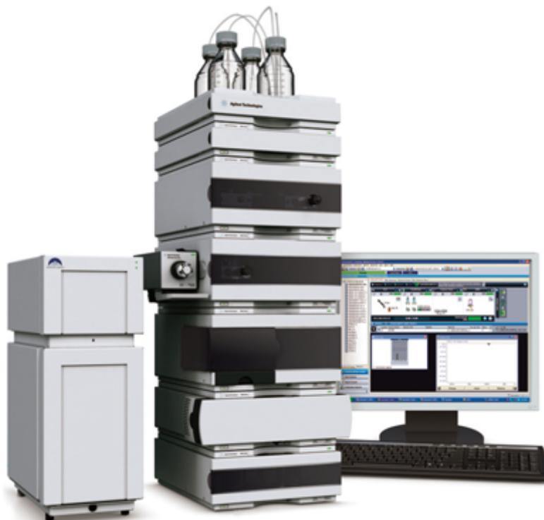
Agilent 1260 Infinity Analytical SFC System является одной из очень небольшого списка систем для сверхкритической флюидной хроматографии на базе жидкостного хроматографа Agilent 1260.
