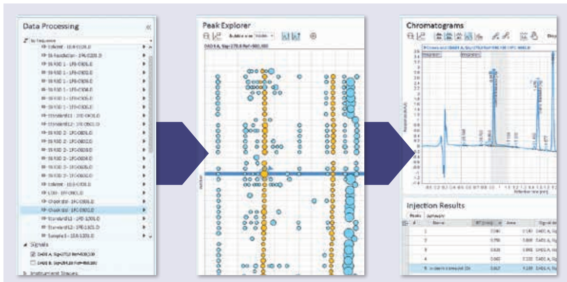
Peak Explorer позволяет быстро идентифицировать пробы с отсутствующими или дополнительными пиками.
