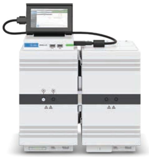
Микро-ГХ Agilent 990 с отделением для дополнительных каналов и опциональным сенсорным экраном для максимальной производительности поддерживает до четырех каналов.
