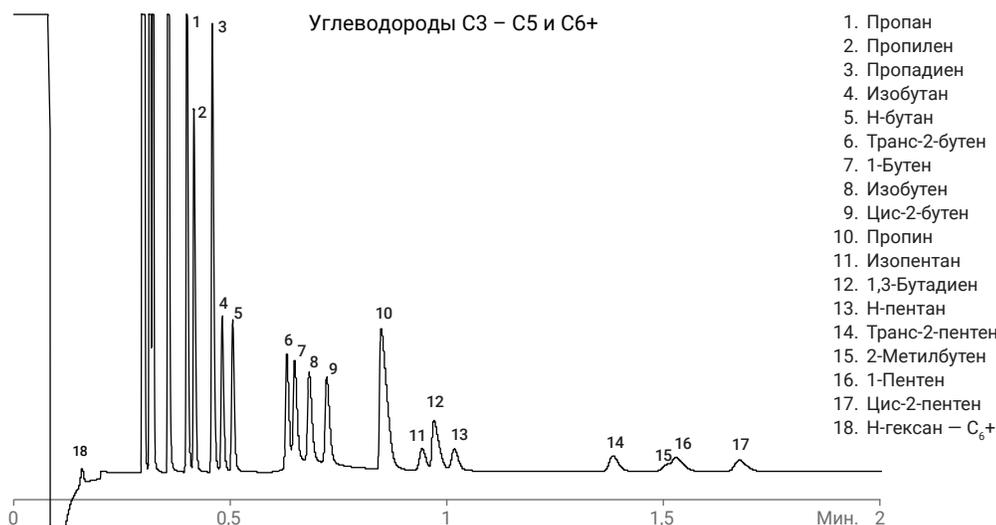
Микро-ГХ Agilent 990 способен определить 17 различных нефтехимических газов менее чем за две минуты.
