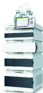
Agilent 1290 Infinity LC - модульный хроматограф для высокоэффективной жидкостной хроматографии при высоком давлении, является продолжением модели Agilent 1260. Все модули для Agilent 1290 Infinity LC работают при давлении до 1200 бар.
