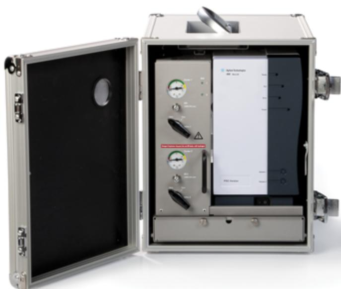
Портативный газовый хроматограф Agilent 490 Micro GC – это исключительно быстрый и точный анализ газов в лабораторных и полевых условиях. Agilent 490 Micro GC обладает надежной компактной платформой для анализа газов, выполняет большее количество анализов за меньшее время, предоставляя вам возможность принимать быстрые и качественные решения. Данная модель является 5-тым поколением приборов, прекрасно зарекомендовавших себя. Agilent 490 Micro GC - максимально
