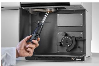
автоматической юстировкой и подключением газов значительно ускоряет запуск прибора и обеспечивает отличную воспроизводимость;
